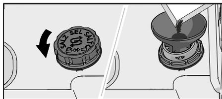
1. Odstráňte príklop zásobníka na soľ otočením proti smeru hodinových ručičiek.
